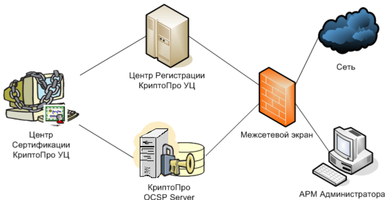
Рисунок 1. Типовая схема взаимодействия компонент КриптоПро УЦ и КриптоПро OCSP Server
