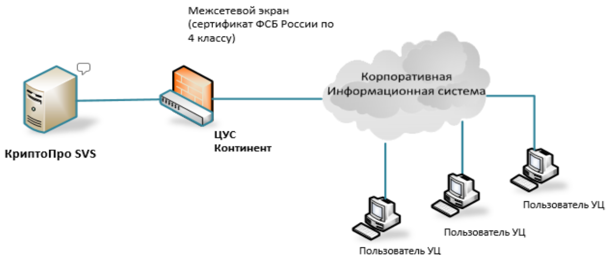
Рисунок 1. Типовая схема подключения КриптоПро SVS к корпоративной информационной системе
